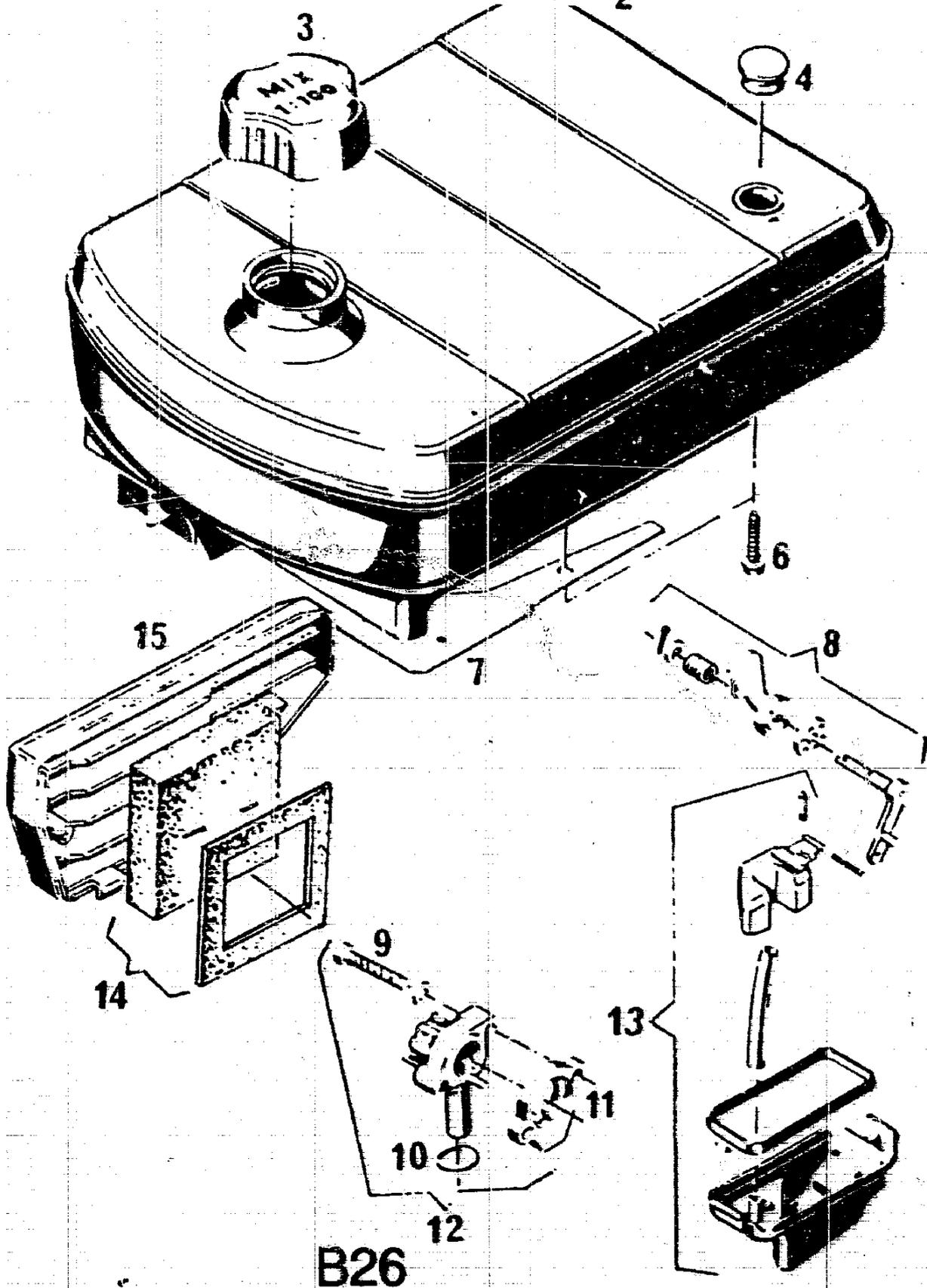
LÜFTERHAUBE MIT KRAFTSTOFFBEHÄLTER, FILTER UND VERGASER SB 130
