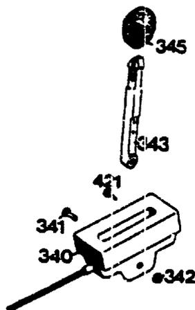
Schaltgehäuse mit Bowdenzug
