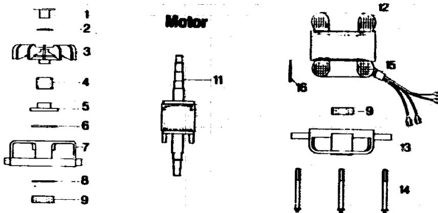
**Motor-Ersatzteile TE 35 CLK**
